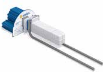
Tronsole® Typ P Schalldämmender Anschluss Podest an Treppenhauswand (optimiert für Fertigteilbauweise)
