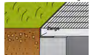
Ohne Falz – bündig zur Schachtaußenkante Gitterrost wird in die Zarge eingelegt.
